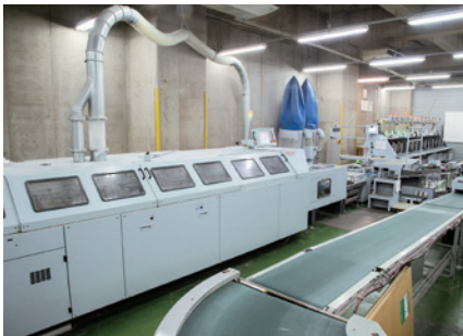
928P+LED-UVの傍に設置された無線織製本ライン
