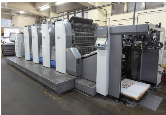
LED-UV 世界初号機を載せて 2009 年に納入された A 全判 4 色機 924+LED-UV
